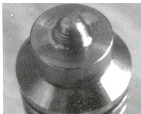
(b) 内凹倾角轴肩结构的搅拌头
