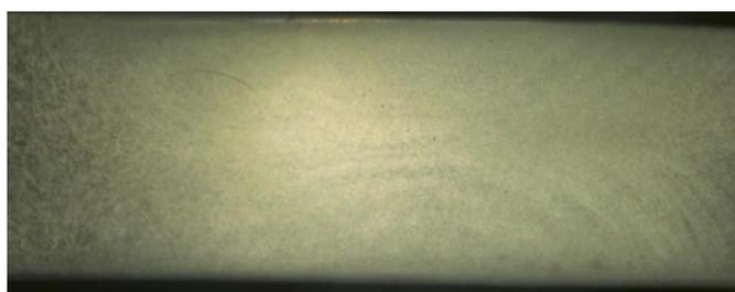
(b) 焊核区试样宏观形貌
