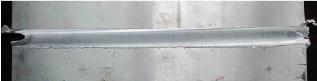
(b) 焊缝反面
